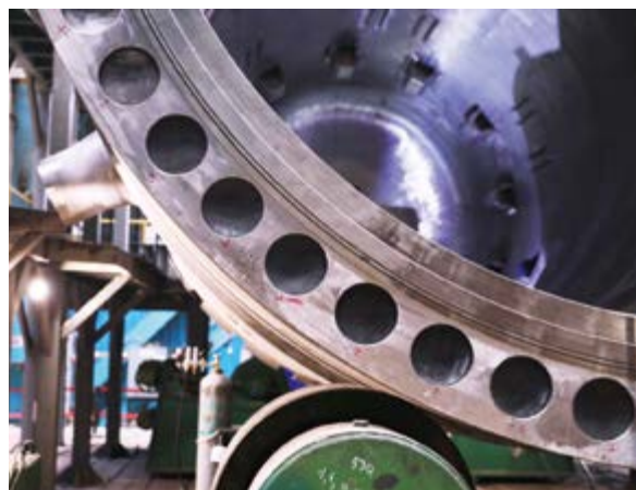
Работы на корпусе атомного реактора для Тяньваньской АЭС в КНР
