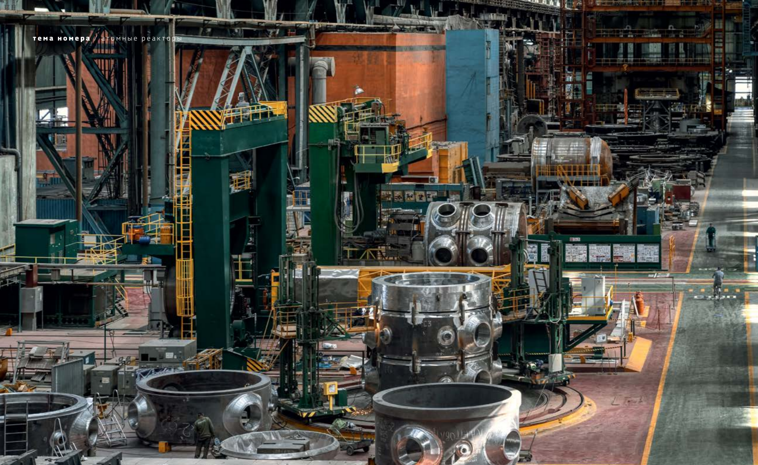
Реактор ВВЭР-ТОИ собирают на заводе Атоммаш в Волгодонске
