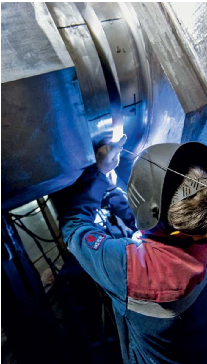
1. Антикоррозионная наплавка отверстий на фланце под установку кассет парогенераторов
