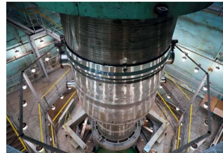
Одна из особенностей МБИР в том, что это тонкостенный реактор: толщина металла колеблется от 25 до 50 мм при диаметре 4 метра (для сравнения, у реактора ВВЭР-1200 толщина металла — 300 мм). Это создавало дополнительные риски при производстве, но задача была решена. Чтобы точно соблюсти все параметры оборудования, Атоммаш использовал специальную оснастку, разработанную его специалистами.
