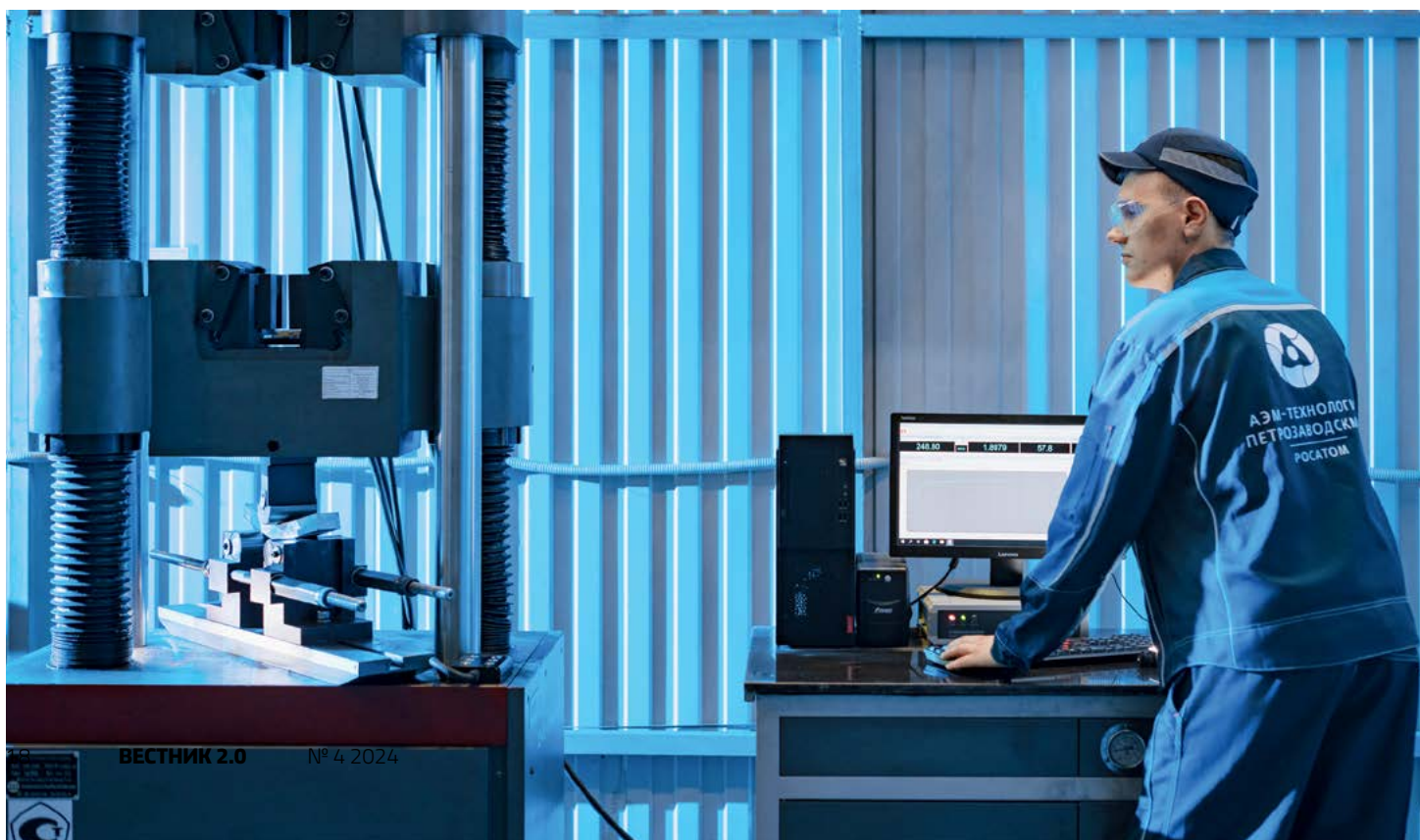
На «Петрозаводскмаш» инженер-лаборант Дмитрий Ларионов проводит механические испытания образцов наплавки
