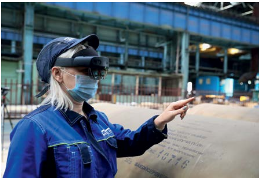
Сдача-приемка продукции на Атоммаше происходит теперь дистанционно с помощью AR-технологий
